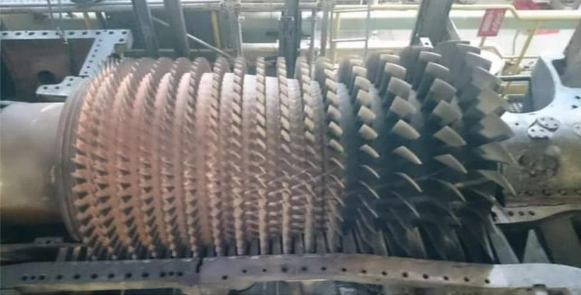
compresseur axial de la turbine à gaz MS5002b
