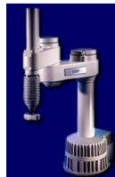
(à gauche) Schématisation d'un porteur RRP SCARA. (au centre) Robot SCARA Epson G10-650. (à droite) Robot SCARA d'Adept Technology.
