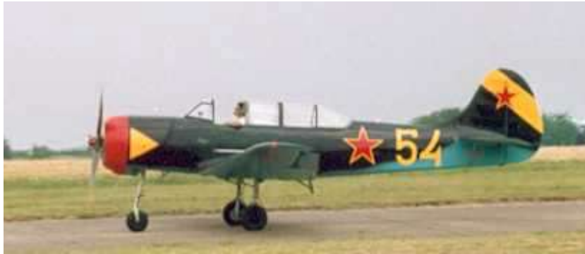
Figure I.40. Avion à Train tricycle
