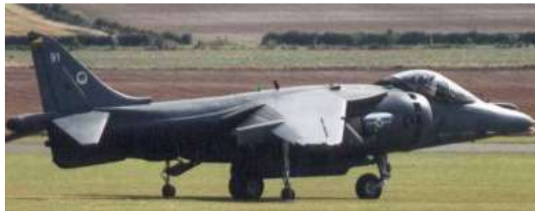
Figure I.41. Avion à train monorace
