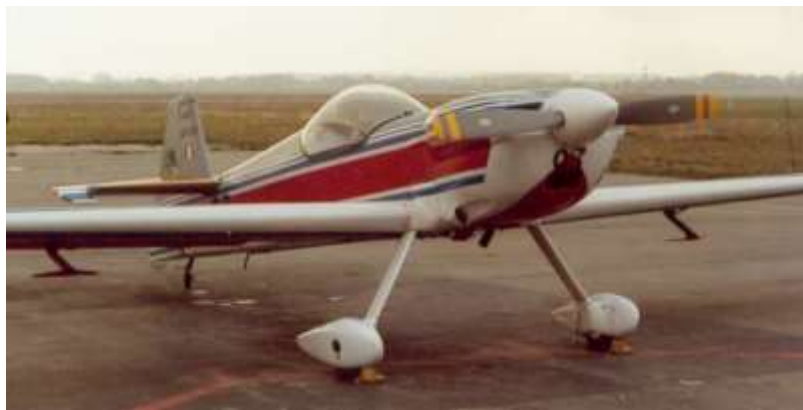
Figure I.39. Avion à train classique
