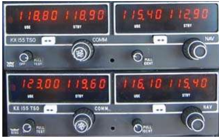
Figure IV.25. Dispositif de réglage de fréquence radio.
