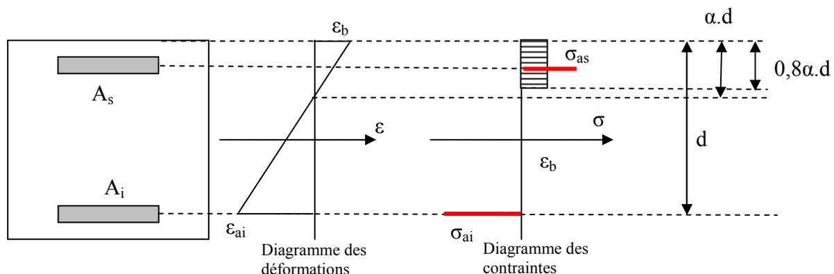
1) Détermination du ferrailage dissymétrique par la méthode d'assimilation à la flexion simple.
