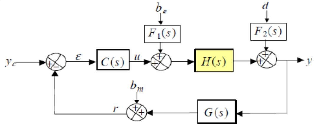
Pour déterminer la FT entre la sortie et une entrée ou une perturbation on applique le théorème de superposition (on considère une entrée ou perturbation et on annule les autres entrées et perturbations).
