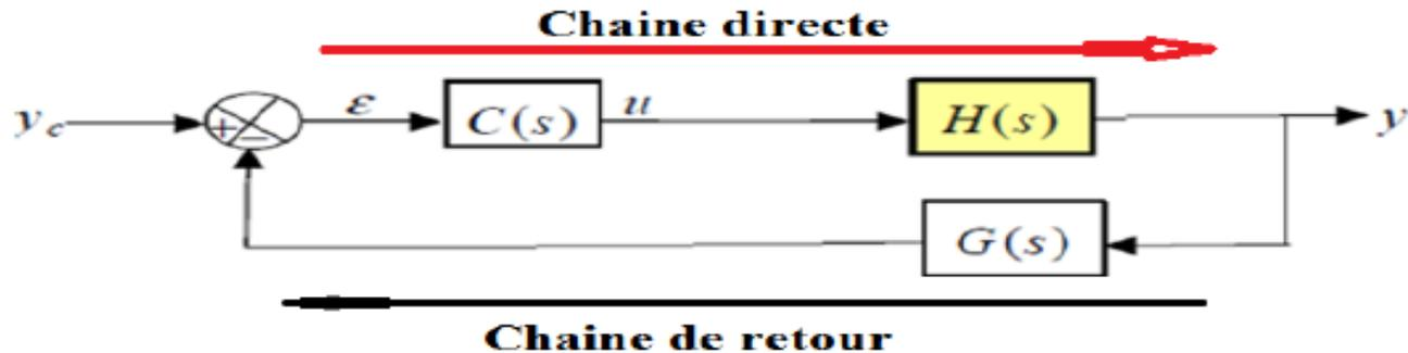
▪ Fonction de transfert en boucle Fermée  $H_{BF}(s)$
