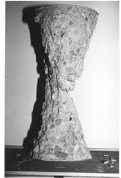
A partir des résultats de cet essai, un béton est défini par une valeur de sa résistance à la compression (notée  $f_{c28}$  en Mpa) à l'âge de 28 jours, dite "**valeur caractéristique requise**".
