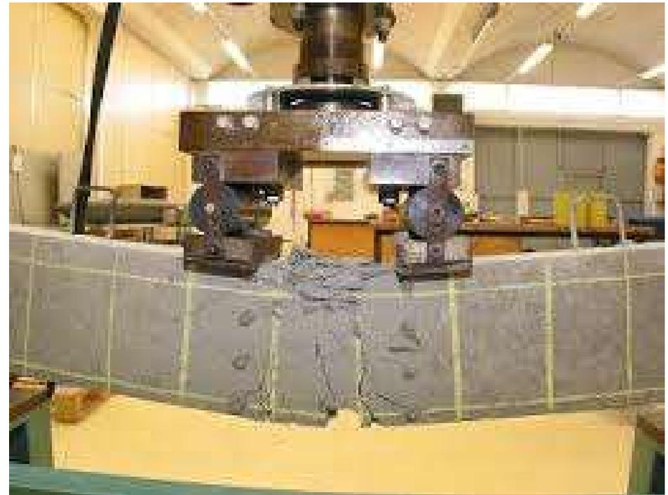
La résistance en compression du béton, de l'ordre de 25 à 35 MPa est 10 fois plus importante que sa résistance en traction.
