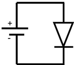
Si  $V_{AK} > 0$ , elle se comporte comme un interrupteur fermé
