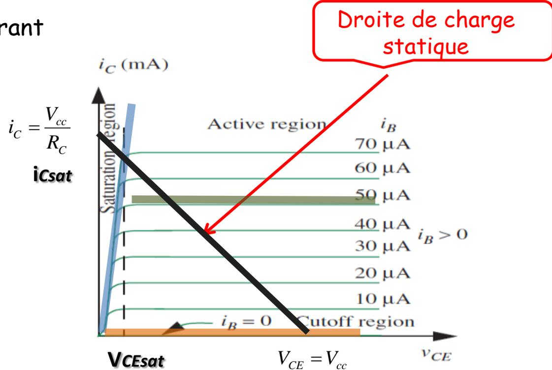
$$i_B = 0 \quad V_{CE} \neq 0$$
