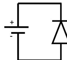
Si  $V_{AK} < 0$ , elle se comporte comme un interrupteur ouverte
