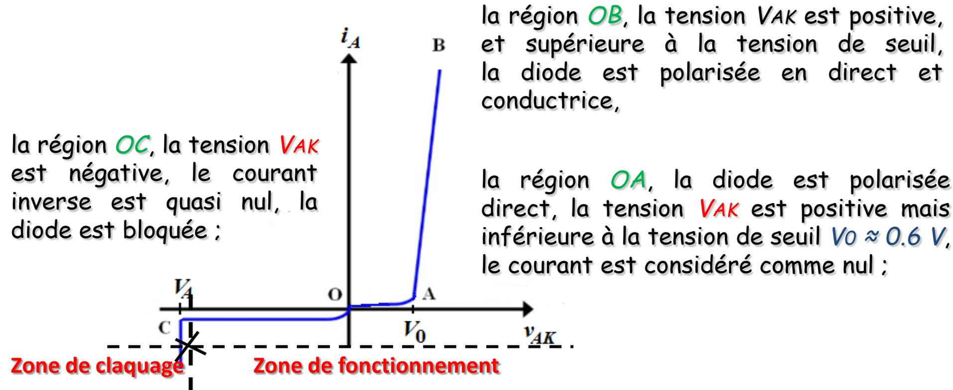
après le point **C**, la tension inverse devient supérieure à  $V_A$ , le courant croit brutalement, c'est le phénomène de claquage de la jonction qui est toujours destructif pour le composant
