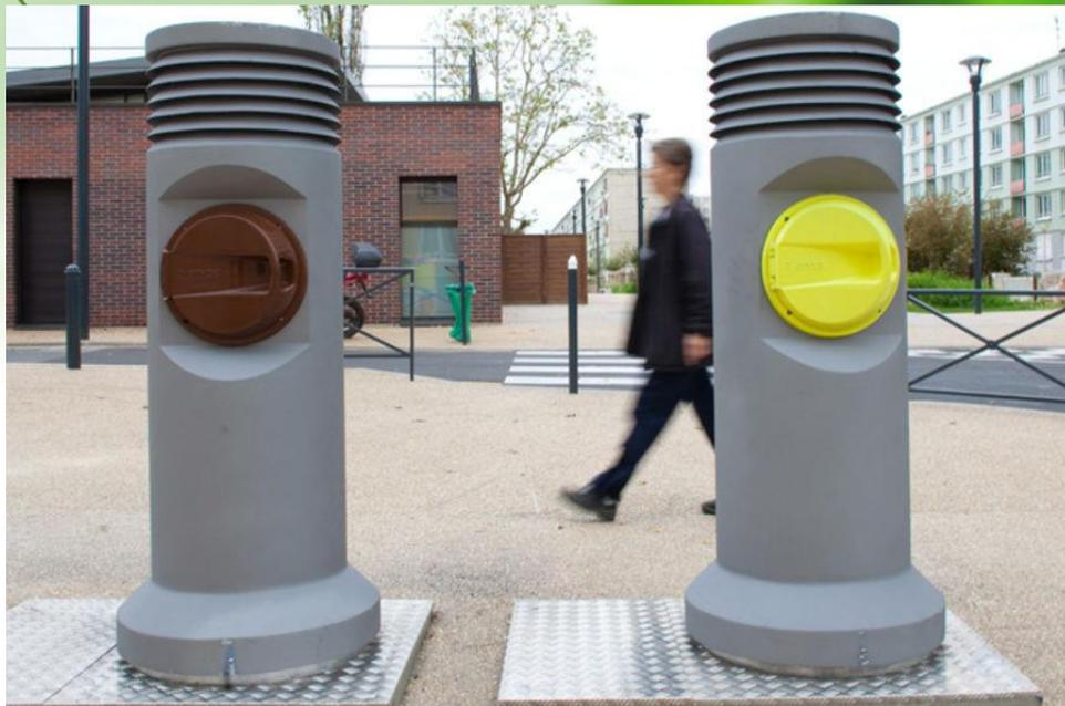
la collecte pneumatique, comparée à une collecte traditionnelle par camion, permet de réduire de 19% les émissions de monoxyde de carbone, de 96% les hydrocarbures totaux, de 91% les émissions d'oxydes d'azote et de 89% les émissions de particules.
