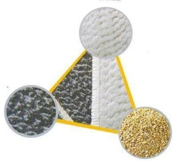
**Un géosynthétique** est un produit dont au moins un des constituants est à base de **polymère synthétique** (polyéthylène, polyamide, polyester ou polypropylène, par exemple). Il se présente sous forme de **nappe**, de **bande** ou de **structure tridimensionnelle**. Il est utilisé en contact avec le sol ou avec d'autres matériaux dans les domaines de la géotechnique et du génie civil.
