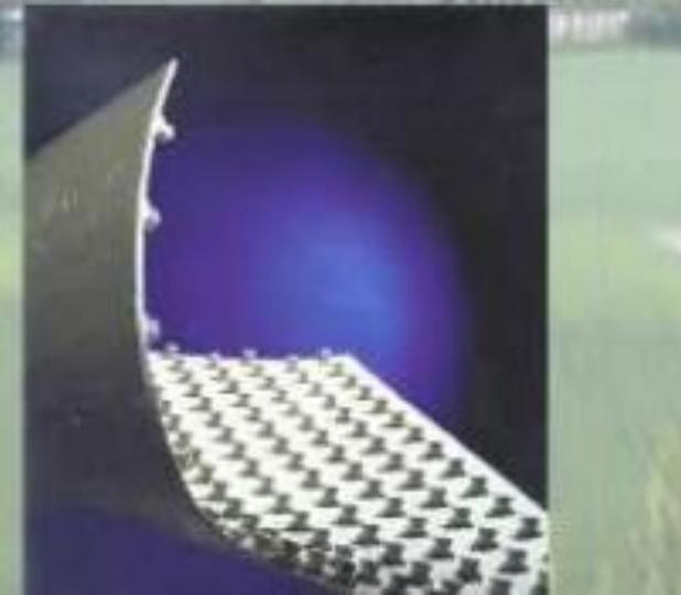
**D**éfinie comme un produit manufacturé adapté au génie civil, se présentant sous forme de lés, d'une largeur minimale de **1,50 m**. Mince, souple, continue et étanche. elle présente une épaisseur effective de **1 mm** minimum sur toute la surface du lé. Elle est soudable en continu par soudure thermique, par vulcanisation ou par bandes adhésives autocollantes selon la nature du produit.
