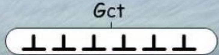
Structure tridimensionnelle permettant le confinement, la stabilité et le renforcement d'un matériau de remplissage.
