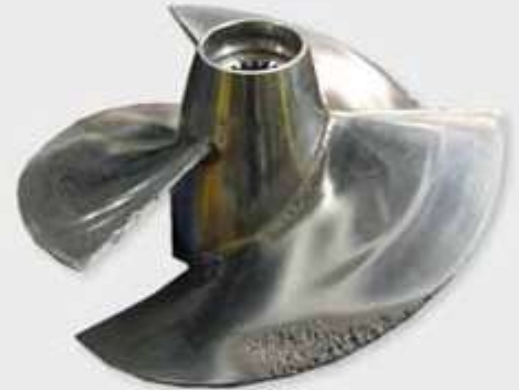
Hélice de bateau détruite par l'érosion
