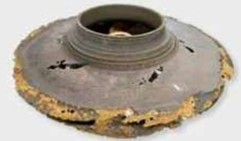
Roue de pompe détruite par l'érosion de cavitation
