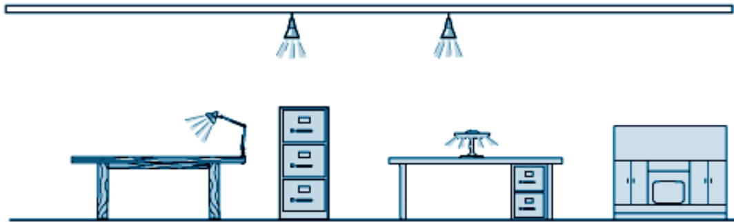
Figure III.4. Éclairage mixte Source : Richard Forster 33
