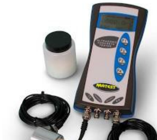
figure 3 : Appareil d'auscultation ultrasonique (Pundit)
