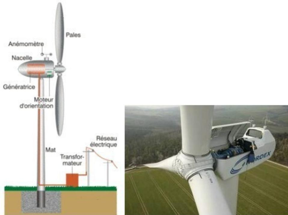
Figure 128. Eolienne à axe horizontal
