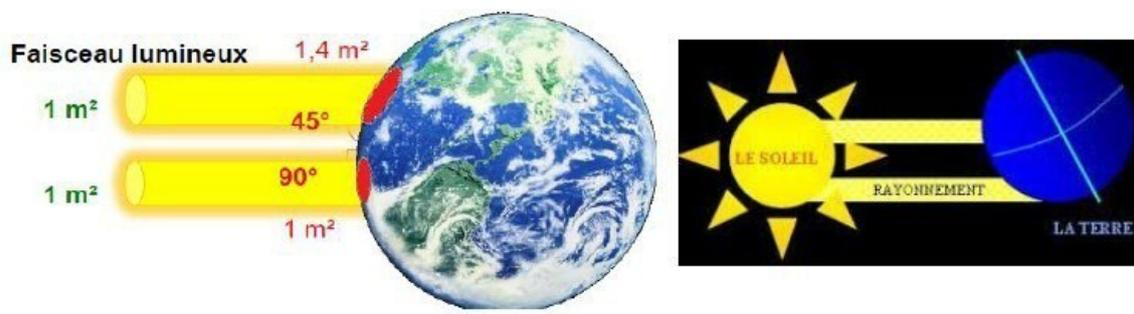
**Figure 111.** Densité du flux solaire
