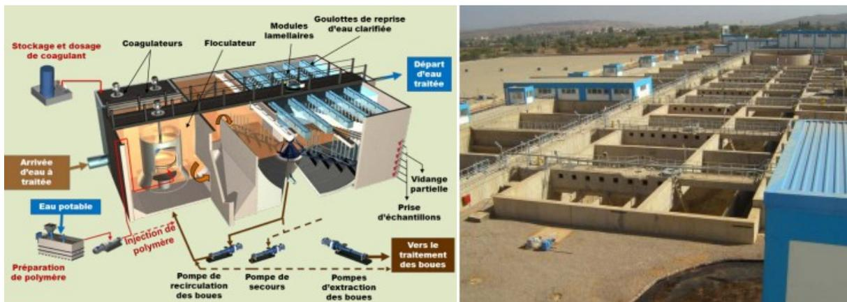
Figure 20. Traitement des eaux potables, étape de clarification
