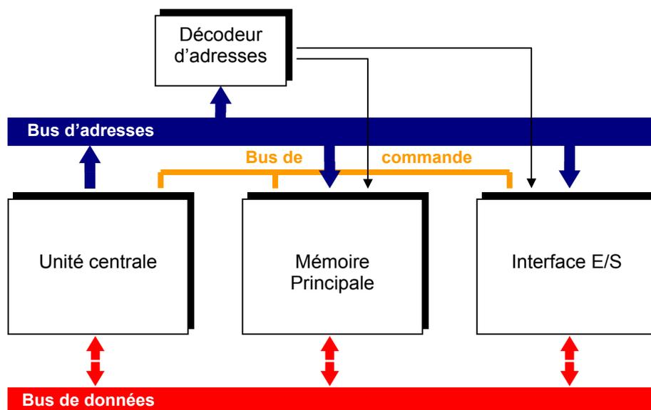
Remarque : lorsqu'un composant n'est pas sélectionné, ses sorties sont mises à l'état « haute impédance » afin de ne pas perturber les données circulant sur le bus. ( elle présente une impédance de sortie très élevée = circuit ouvert ).
