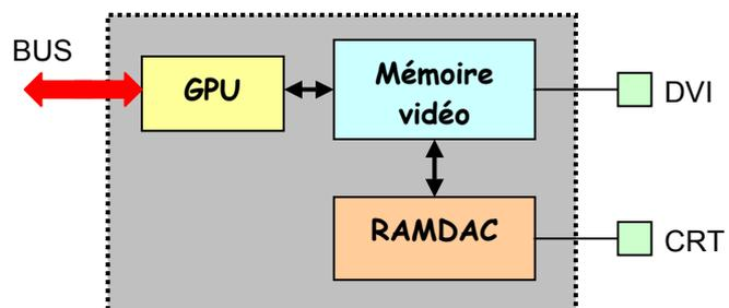
La carte vidéo communique avec la mémoire centrale et le microprocesseur par l'intermédiaire d'un bus. Actuellement, c'est le bus AGP qui est le plus utilisé mais il va progressivement être remplacé par le PCI Express qui présente des débits beaucoup plus élevés (8 Go/s contre 2 Go/s).
