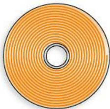
Plusieurs technologies différentes existent en fonction du type de CD : CD-ROM, CD-R, CD-RW. Le principe de lecture/écriture utilise un rayon infrarouge d'une longueur d'onde de 780 nm.
