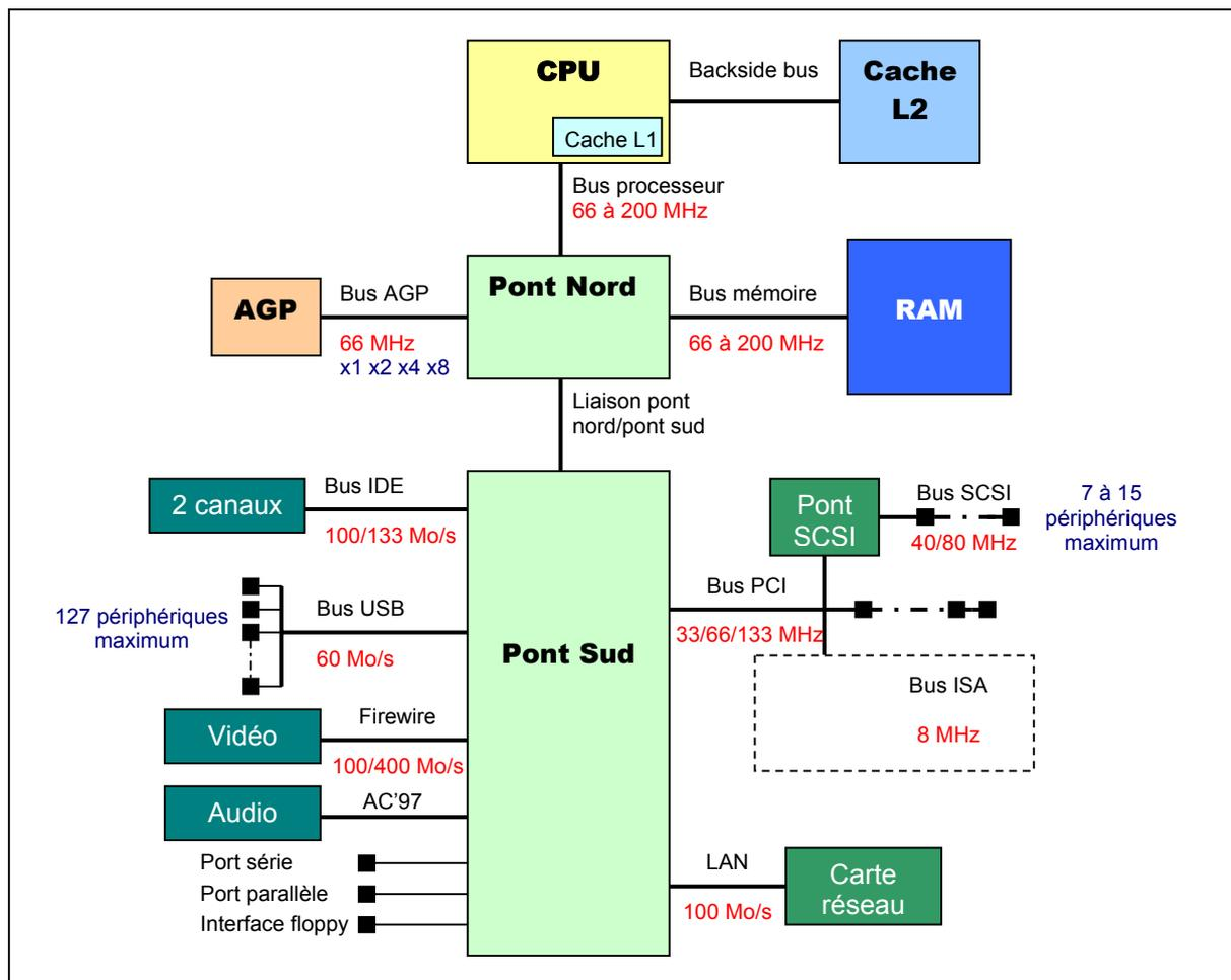
Ici le chipset est composé par deux composants baptisé Pont Nord et Pont Sud. Le pont Nord s'occupe d'interfacer le microprocesseur avec les périphériques rapides (mémoire et carte graphique) nécessitant une bande passante élevée alors que le pont sud s'occupe d'interfacer le microprocesseur avec les périphériques plus lents (disque dur, CDROM, lecteur de disquette, réseau, etc...).
