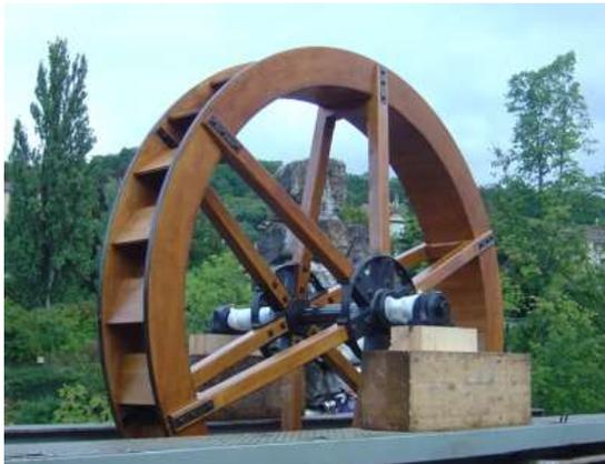
**Dans les pompes à capacité** (aussi appelées machines élévatoires), le liquide est enfermé dans une capacité qui est élevée à une cote désirée. C'est le cas des roues à augets, chaînes à godets, norias, des vis d'Archimède.
