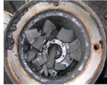
Rupture des aubes d'une pompe
