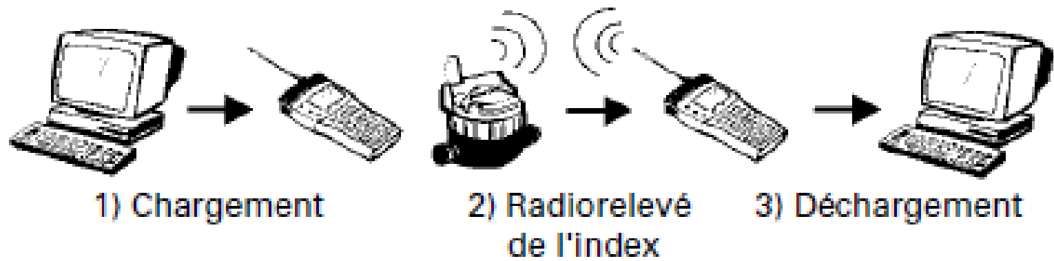
Figure 9 – Chaîne de traitement par radiorelevé
