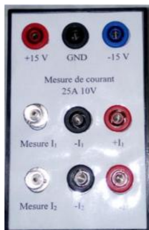
Figure A8. Boîtier d'un capteur de mesure pour 2 courants réalisé au LAT 7
