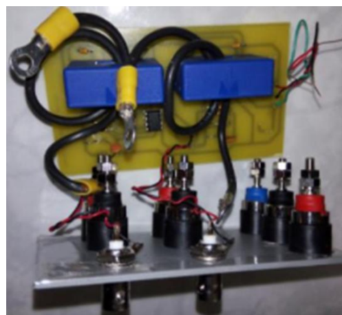
Figure A8. Boîtier d'un capteur de mesure pour 2 courants réalisé au LAT 7
