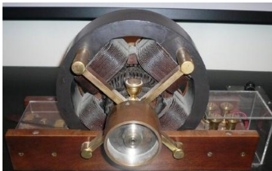
Figure I.2. Maquette du premier moteur à induction de Nikola Tesla (Musée Tesla de Belgrade, Serbie)
