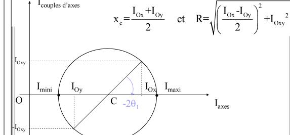
Le cercle de Mohr permet la détermination graphique des axes principaux et des moments correspondants, on connait, lx, ly et lxy pour un système d'axes.
