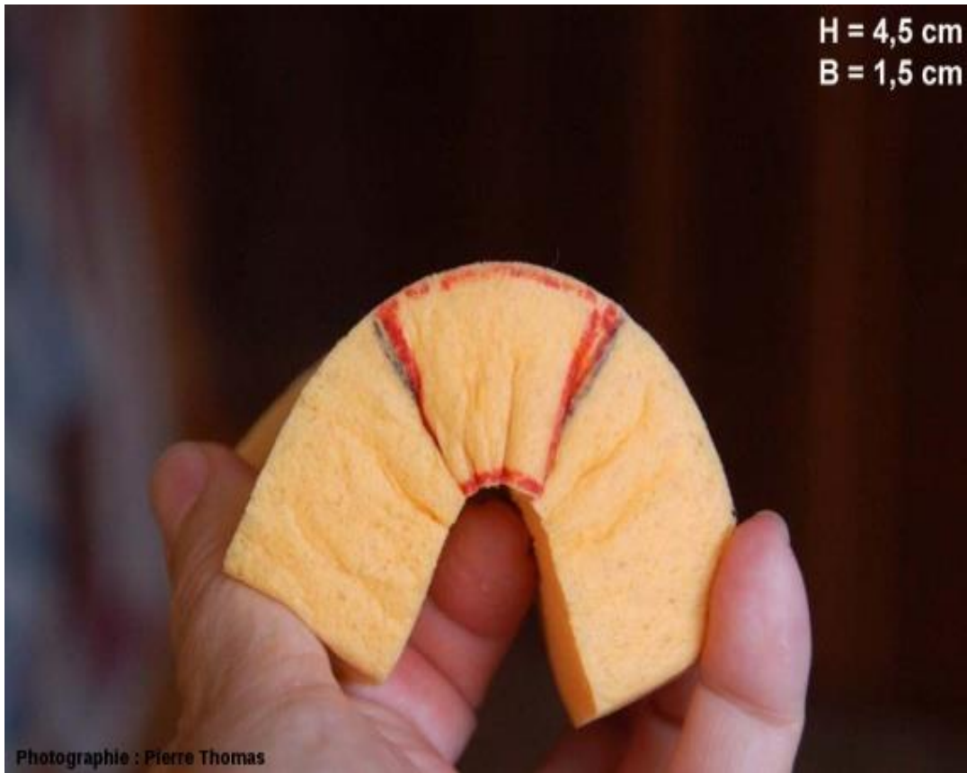
Figure 9. Simulation analogique de déformation d'extrados / intrados : raccourcissement de 3 cm
