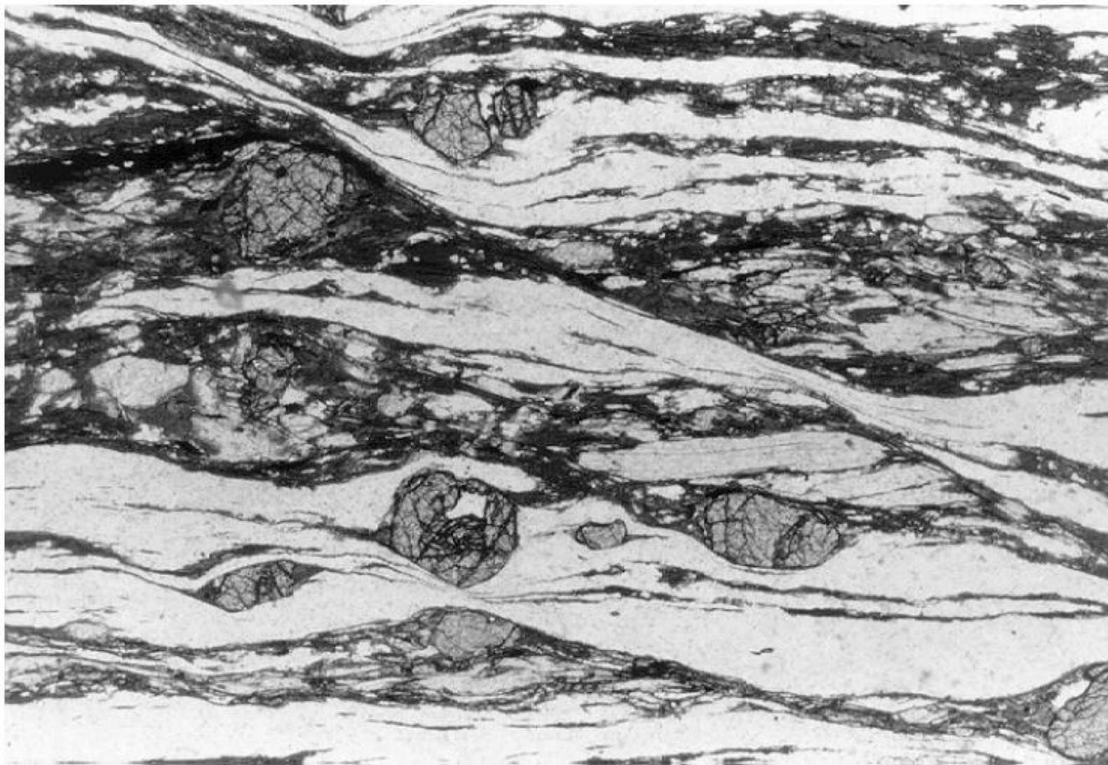
Figure 62. Fabrique S/C' dans un schiste à grenats.
