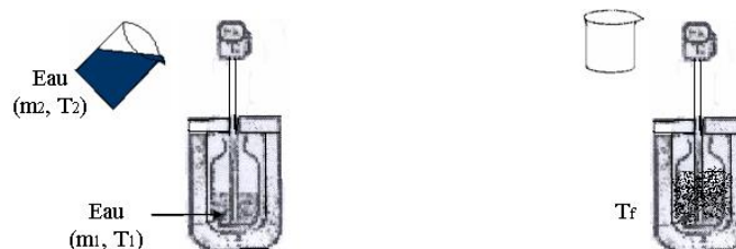
Figure 1. Mesure de la capacité calorifique du calorimètre
