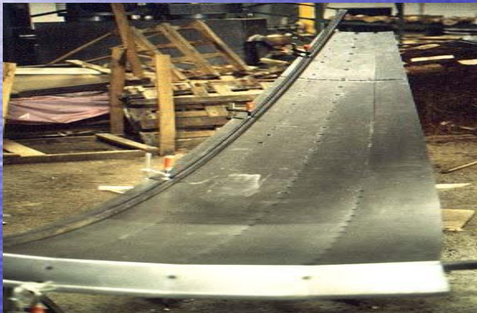
Soudage des deux premières lames sur le galbe.
