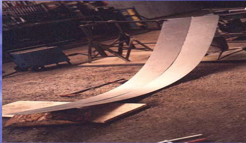
Soudage des deux premières lames sur le galbe.
