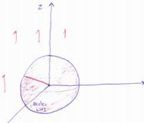
On a un dielectrique LHI placé dans un champ  $\vec{E}_0 = E_0 \vec{e}_z$  (uniforme)
