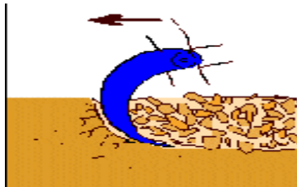
Schéma du mode d'action d'un décompacteur rotatif
