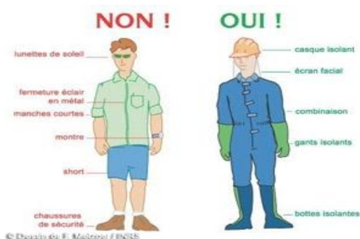
Figure VI.13 : La tenue réglementaire d'un opérateur électrique
