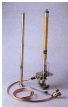
Figure VII.18 : Perche de piquage pour câble souterrain
