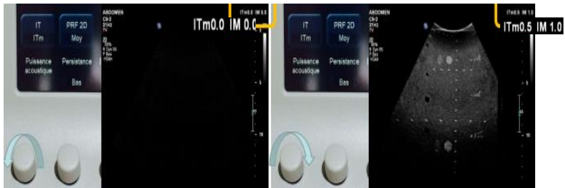
Figure IV.35 : Effets de la modification de la puissance acoustique. En baissant la puissance, on fait disparaître l'image, en l'augmentant, on augmente l'intensité de l'image. La pénétration du signal est améliorée. En corollaire, le bruit et les artéfacts sont majorés.
