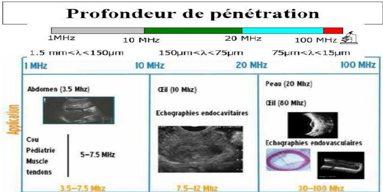
Figure I.5. la longueur d'onde en fonction de fréquence dans les différentes applications échographiques
