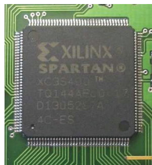
Figure 1.2 : FPGA de Xilinx (modèle Spartan XC3S400) avec 400 000 portes.
