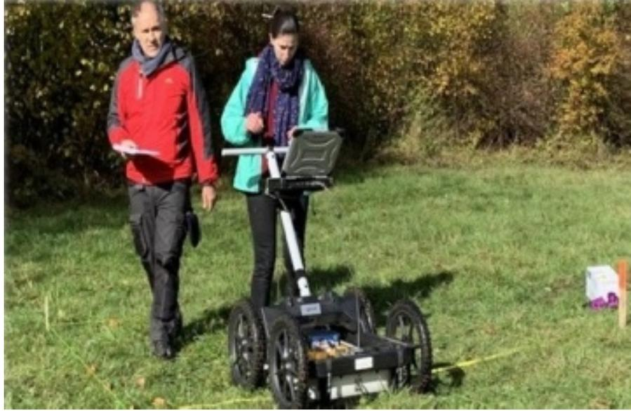
الصورة 05 : استخدام جهاز الماغنتومتر في عملية المسح
