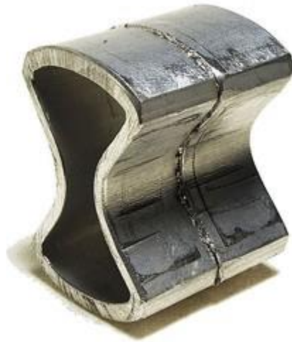
Figure 13: Soudage par friction orbital de profilés creux (source: Dyconn)
