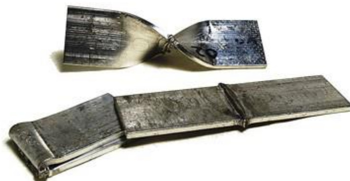
Figure 12: Soudage par friction orbital de plaquettes d'aluminium (source: Dyconn)
