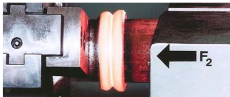
Figure 6: La partie en rotation est freinée et la force de forgeage F_2 est exercée (source: Kuka)
