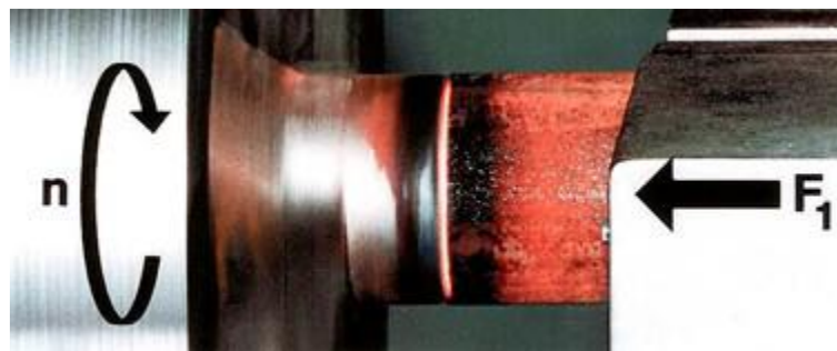
Figure 5: Les pièces sont mises en contact l'une de l'autre avec la force de friction F_1 : la température augmente dans la surface de contact (source: Kuka)
