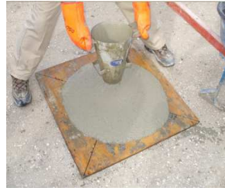
Schématisation de l'essai d'étalement au cône d'Abrams
