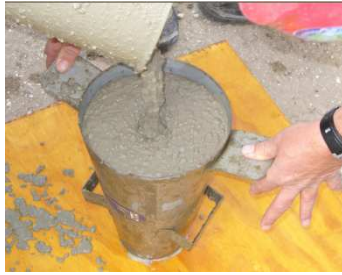
Schématisation de l'essai d'étalement au cône d'Abrams
