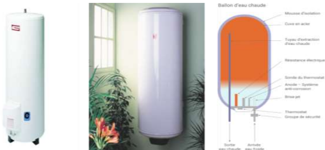
Figure III.2 : Chauffe-eau électrique à accumulation
