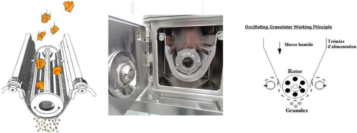
**Figure 33: Granulateur oscillant.**
