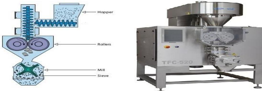
Figure 39: Presse à cylindre (Compacteur à rouleaux).
