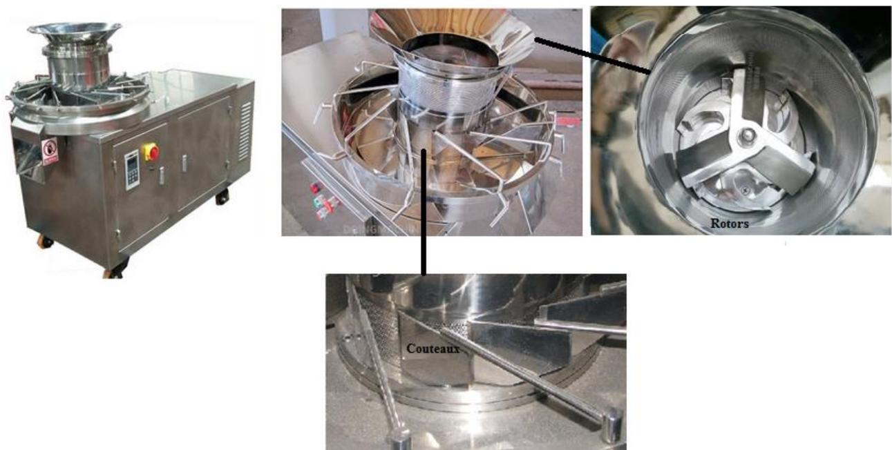
**Figure 34: Granulateur rotatif.**
