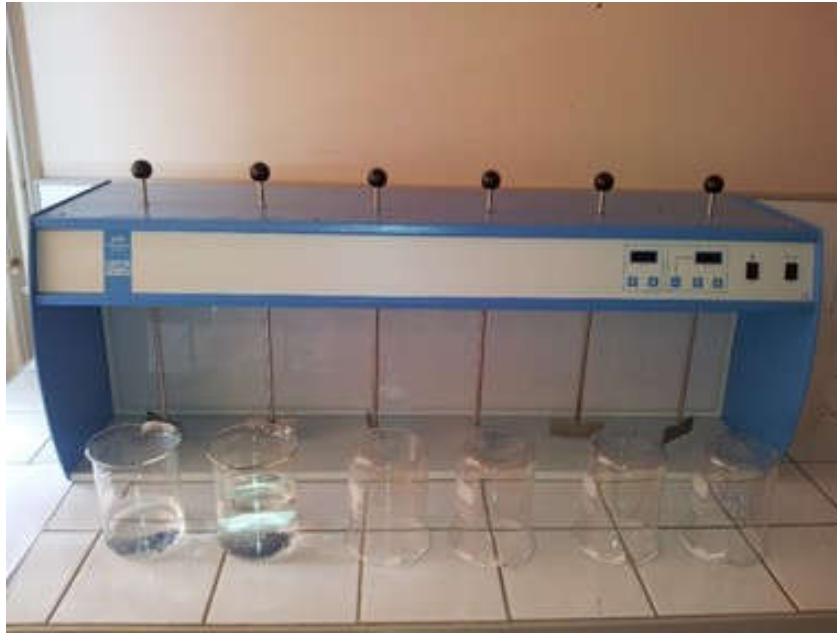
Jar-test utilisé pour la coagulation-floculation-décantation
