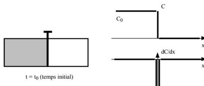
Quand on ouvre la glissière centrale les molécules diffusent progressivement de la façon indiquée sur les graphes, en fonction de  $x$ . En outre, à chaque instant, les courbes évoluent car les fonctions
