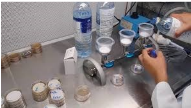
Recherche et dénombrement des micro-organismes par la technique de la filtration sur membrane
